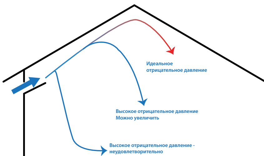
Рис. 32: Применение отрицательного давления для контроля скорости воздуха.
